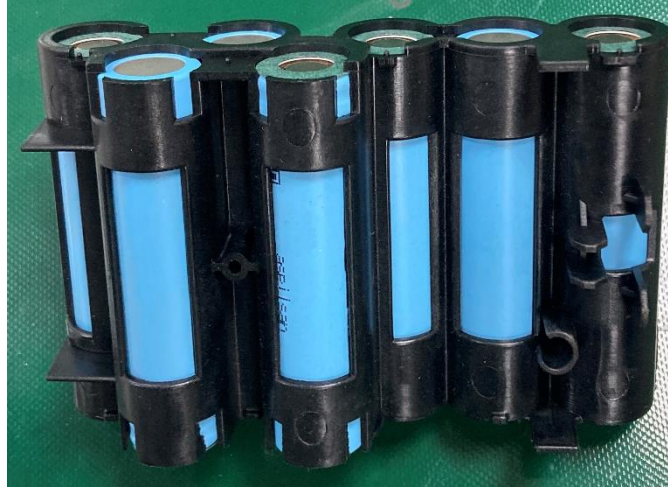
Şekil 2: 7 adet Li-iyon pilin karkasta gösterimi
